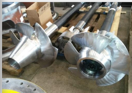
Nya rostfria löphjul med ny bladprofil, renoverade axlar och nya rostfria lagerytor
