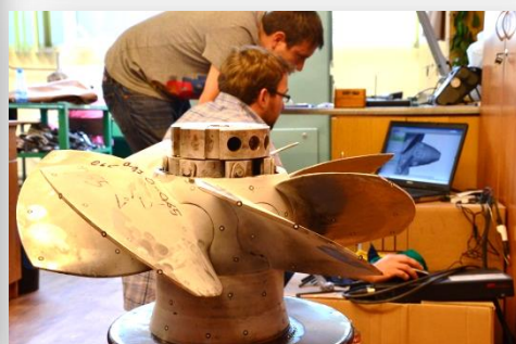
3D-scanning av gamla löphjulet
