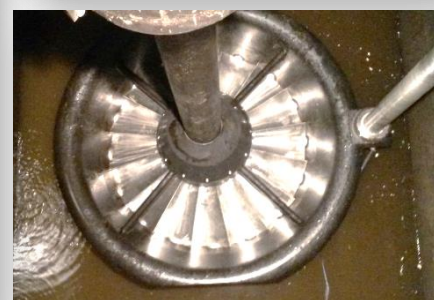
Ny ledskeneapparat och regleraxel
